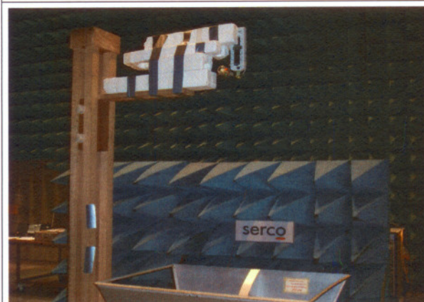
HF-Analyser mit Antenne UBB27_G3 über der Sendeantenne (300 MHz bis 1 GHz)
