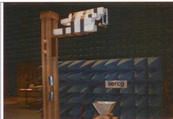
HF-Analyser mit Antenne UBB27_G3 über der Sendeantenne (1 GHz bis 3 GHz)
